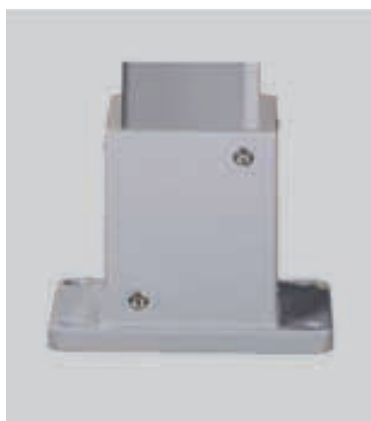
品名: 底座 Part name: support 订货号: 5313800 Order number: 5313800 重量: 5kg Weight: 5kg 材料: 铸钢 Material: cast steel 不可旋转 Not rotatable.
