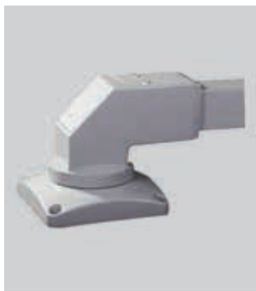
品名: 顶座 Part name: top seat. 订货号: 5315800 Order number: 5315800 重量: 12.5kg Weight: 12.5kg 材料: 铸钢 Material: cast steel 可水平旋转 0-320° Horizontal rotation: 0-320°
